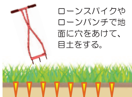
エアレーション作業
